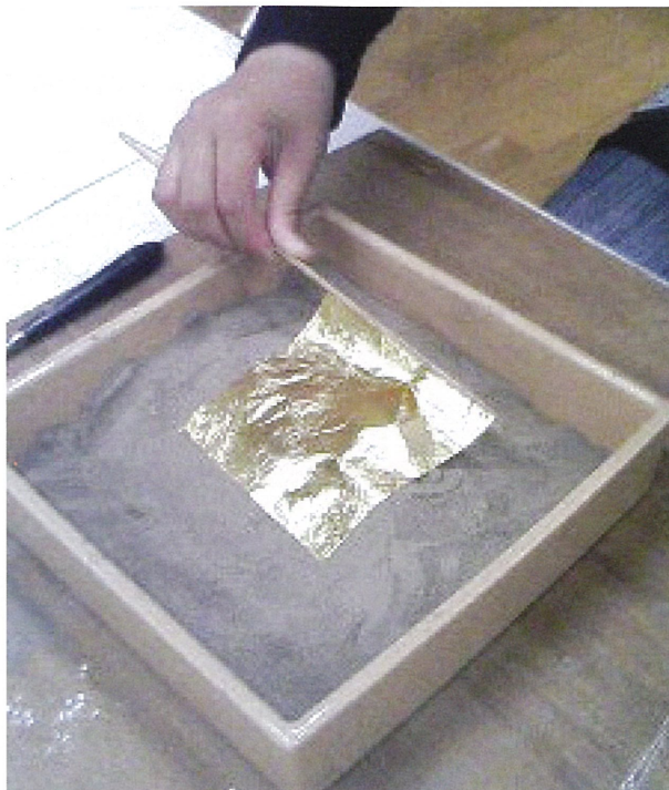
図1 金箔を二枚重ね、箔箸ではさみ、熱した灰床であぶる
