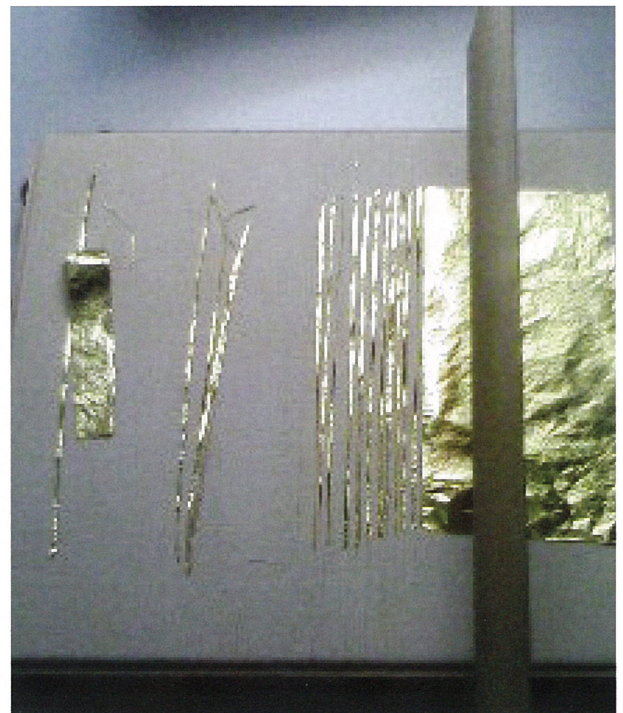
図2 焼き合わせた金箔を箔台にのせ、竹刀を用いて切る
