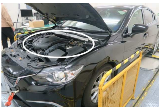
図 6.1 吸音材取り外し箇所
