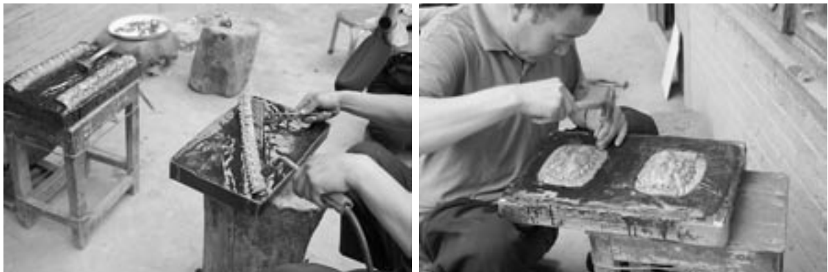
写真2 (6) 制作段階：ヤニ板での鍛金作業（仏塔部品） 写真2 (7) 制作段階：ヤニ板での鍛金作業（仏塔基壇部品）
