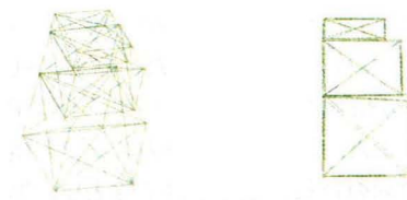
図 28: 本手法により頂点間に 3 角面を構成した形状復元, 上図 (左), 横図 (右)
