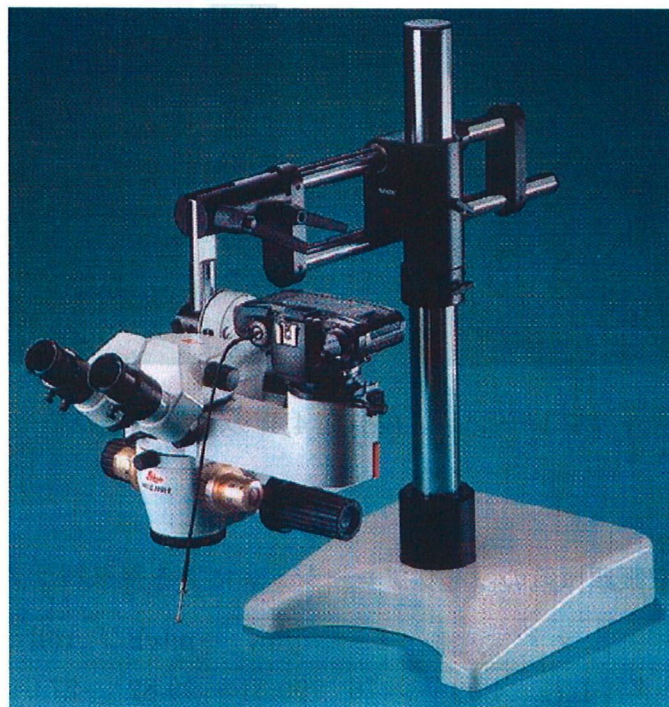
図 4.2: 単対物双眼顕微鏡 Leica M651
